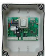
**BIOS 2** Centralina per cancelli a 1 o 2 battenti. Disponibile anche in versione economica. Regolazione di coppia elettronica, memoria estraibile, selezione funzioni tramite display, autoapprendimento delle corse, rallentamenti differenziabili in apertura e chiusura. Centralina con gestione di un trasmettitore tramite display. Rilevamento ostacoli regolabile e autodiagnosi dei dispositivi di sicurezza solo per centralina completa.
